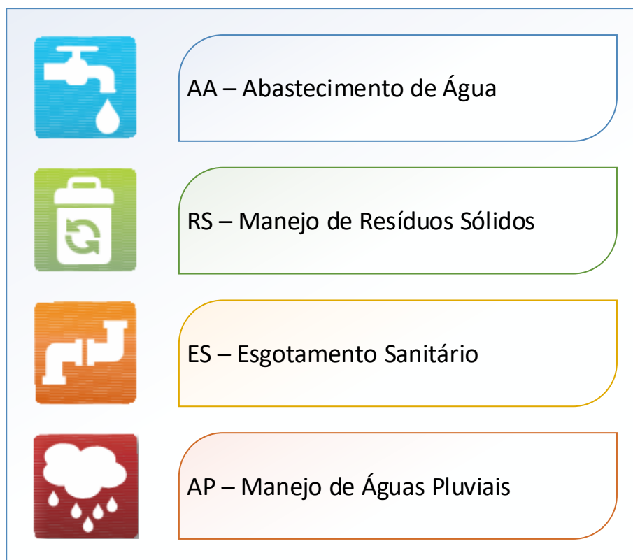
Figura 3.2 – Codificação dos Sistemas de Saneamento
