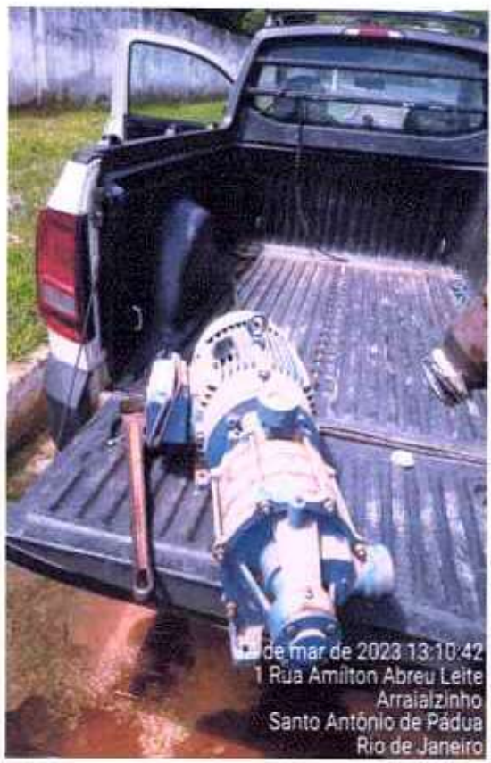
Figura 9 e 10 ; substituição de bomba para manutenção preventivas com lubrificação e troca de rolamentos, no caso foi feita a substituição da bomba para não parar o sistema.
