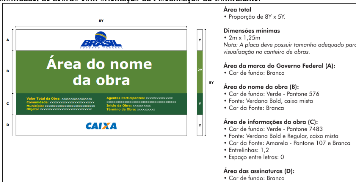
Figura 01 – Modelo de placa de obra (Fonte: http://www.caixa.gov.br/Downloads/gestao-urbana-manual-visual-placas-adesivos-obras/Manual_PlacadeObras.pdf )
