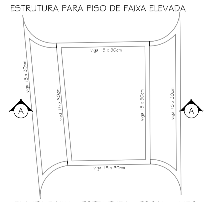
PLANTA BAIXA - ESTRUTURA - ESCALA: 1/50
