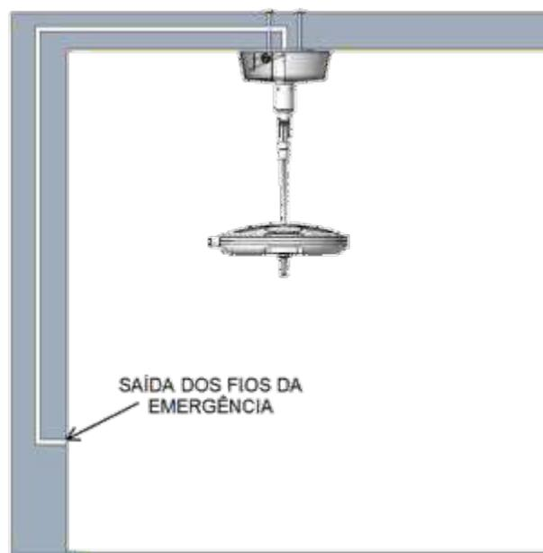
FIGURA 58 – PASSAGEM PARA OS FIOS DO SISTEMA DE EMERGÊNCIA NA INSTALAÇÃO PREDIAL
