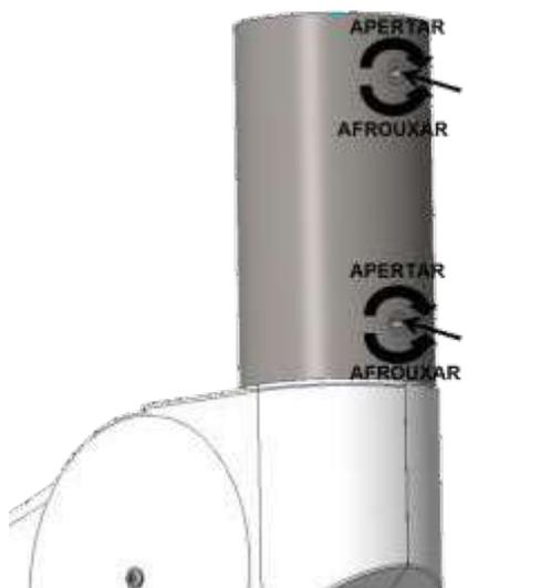
FIGURA 67 – SENTIDO DE AJUSTE DO FREIO DO GIRO DO SPRING ARM
